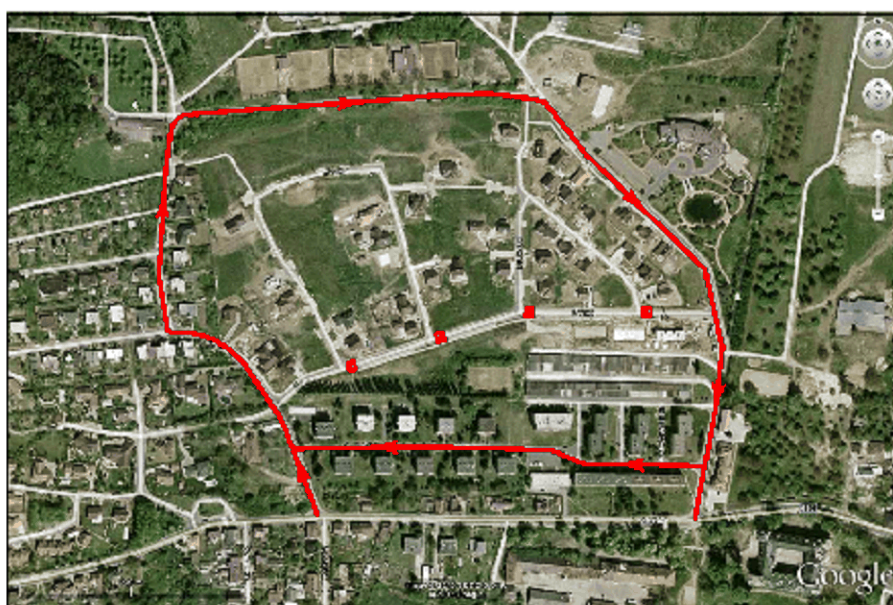
Schéma možného průjezdu lokalitou jak osobní tak hromadné dopravy s vyznačenými retardéry
